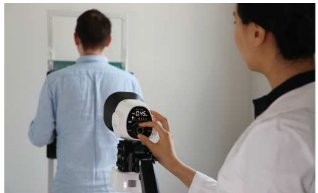
차과용 영상장비 전문제조기업 바텍의 디지털 X-선원 기반의 포터블 엑스레이 장비의 예 (출처: 바텍뉴스 "바텍, 코로나 19 진단 최적화된 초경량/저선량 포터블 엑스레이 출시" 2020. 07. 27.)
